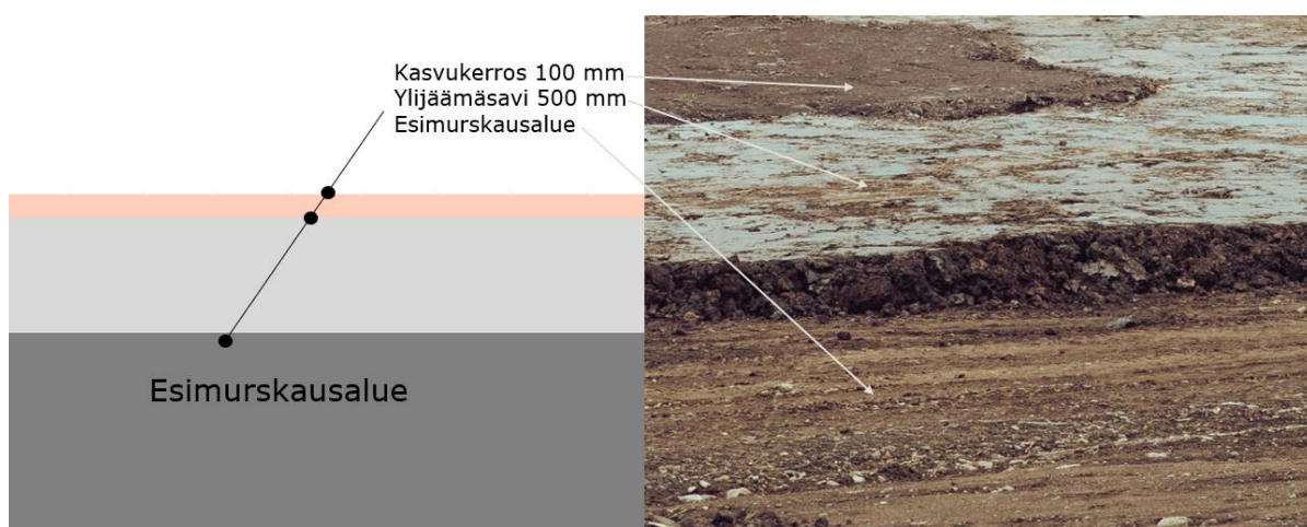
Kuva 7. Savipeiterakenteen poikkileikkauskuvat vasemmalla ja valmis rakenne oikealla.
